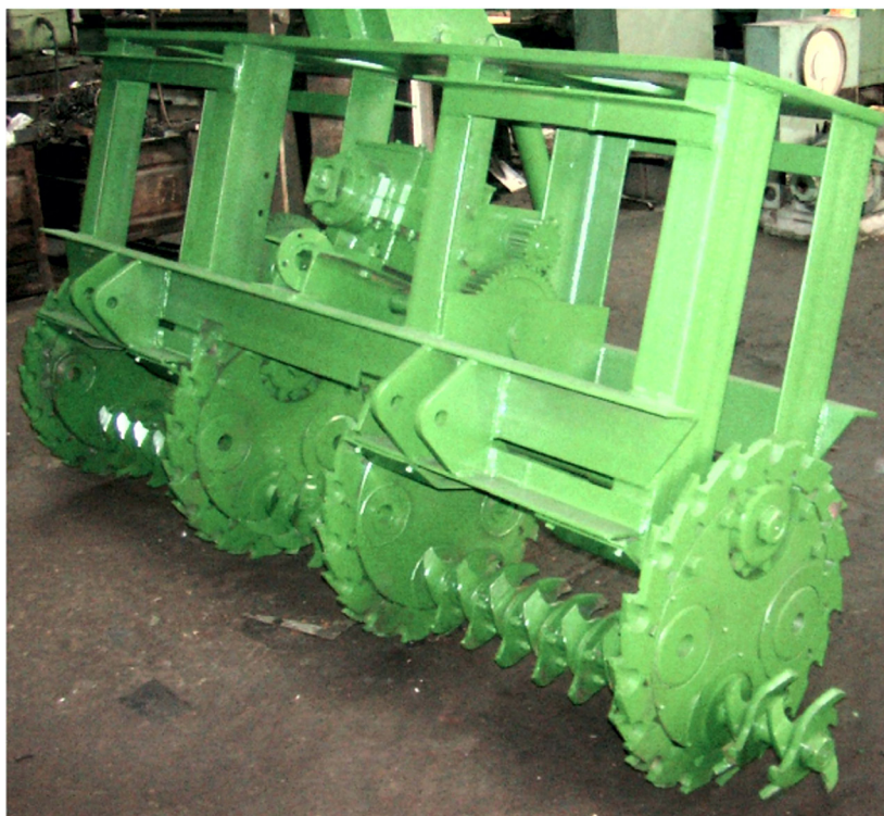
Рис. 5. Орудие ПМС-260 (2008 год) для внутрпочвенной фрезерной обработки почвы [38]
