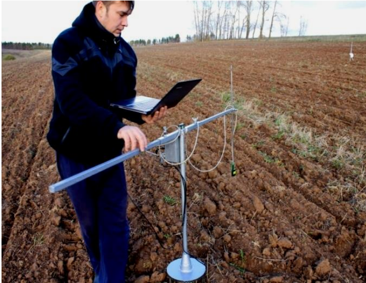
Рис. 5. Полевые исследования с помощью профилографа и их результаты в полярных координатах
